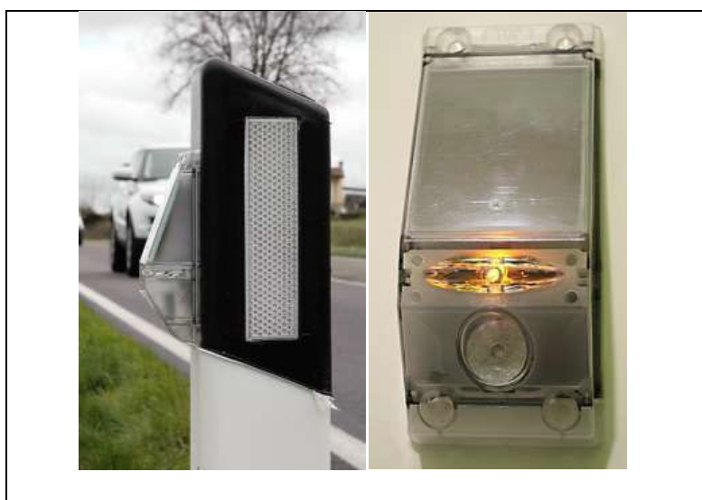
Fig. 100 – Il dissuasore elettronico (acustico-visivo) utilizzato a Piacenza e Reggio Emilia. A sinistra posizionato su marginatore stradale; a destra si notano il pannello solare, il led luminoso in funzione e il microfono.
